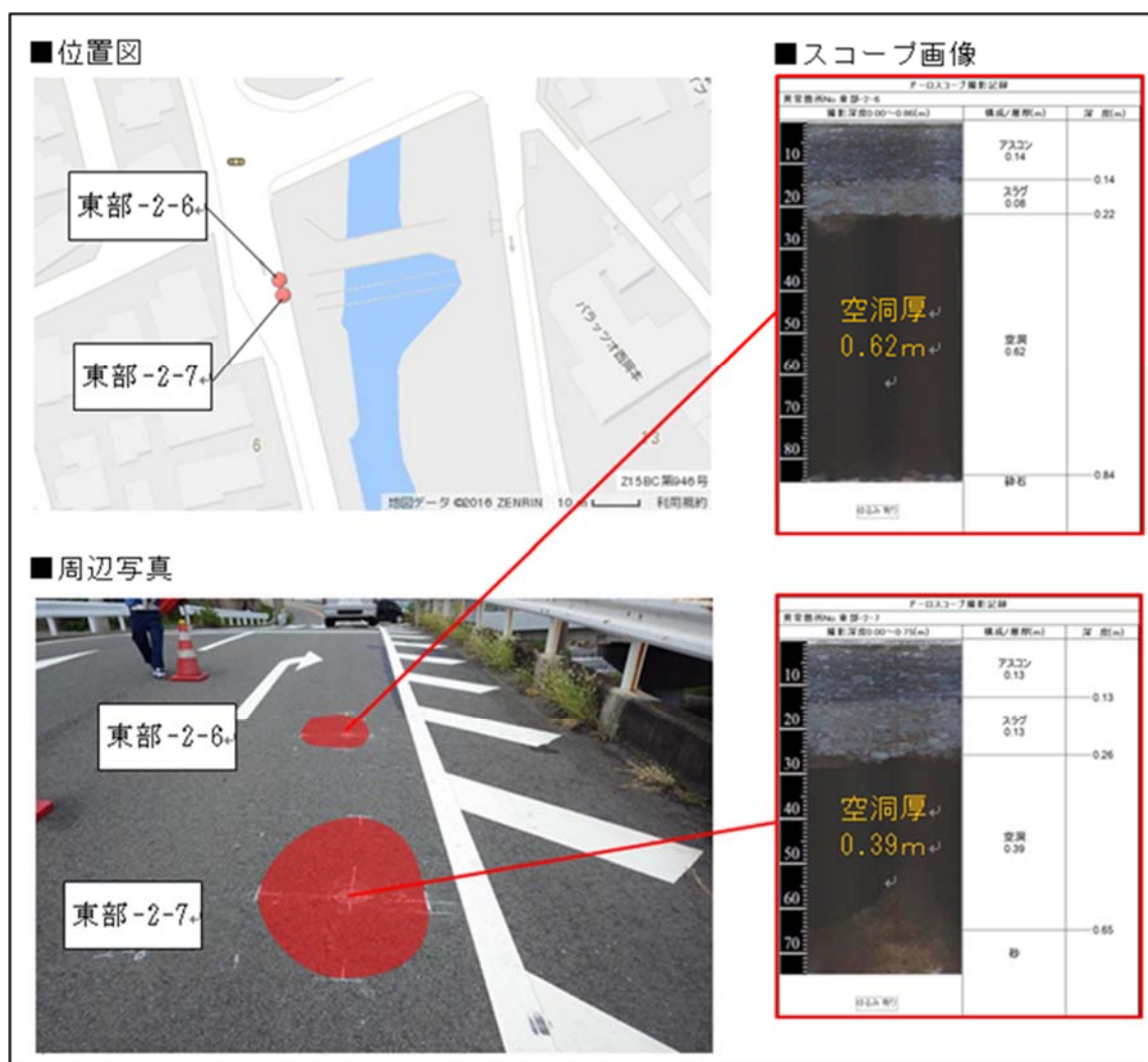
図-6.2.2 (事例) 構造物背面土砂の吸出し
