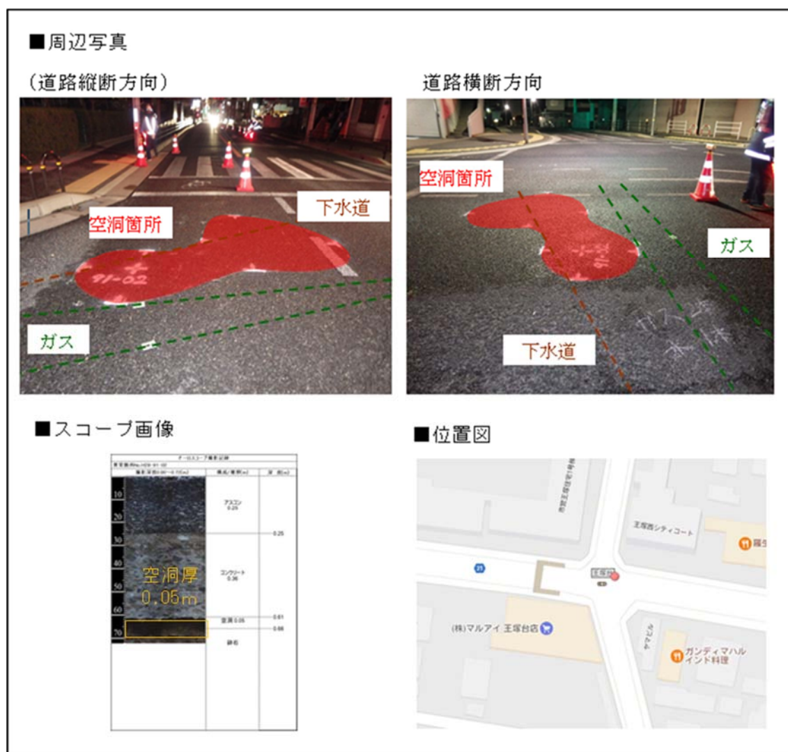
図－6. 2. 7 (事例) 地下埋設物埋戻し土の転圧不足
