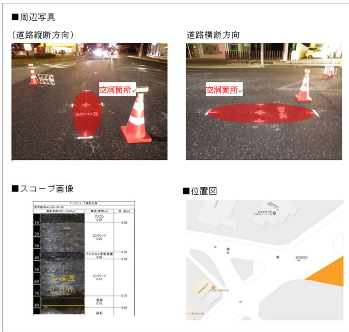
図ー6.2.13 (事例)コンクリート版の不等沈下
